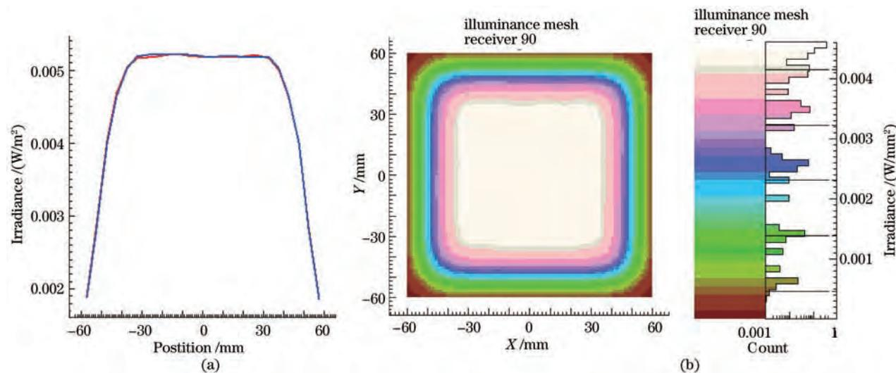
图 8 (a)辐照面上辐照度的线图表; (b)辐照面上辐照度的栅格图表
