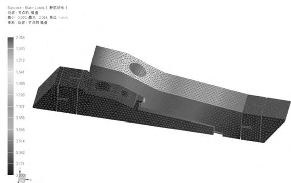
图3 单条柔性支链位移变化云图
