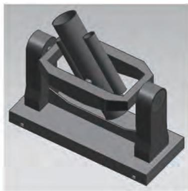
图2 水平式光电经纬仪结构
