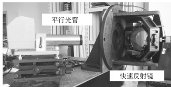
图 12 快速反射镜测试平台 Fig. 12 Test platform of FSMs
