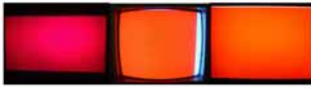
图8 红色在色域转换前的激光电视(左)、荧光粉电视(中)和经过色域转换后的激光电视上的显示效果(右)
