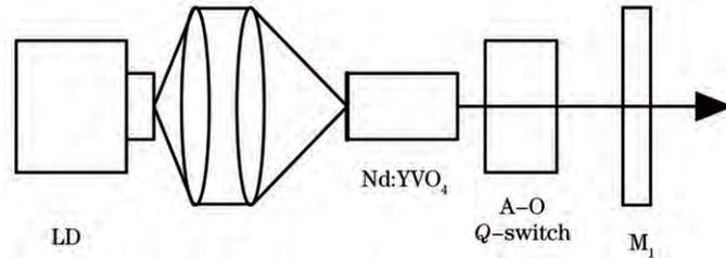
图3 声光调Q实验装置图
