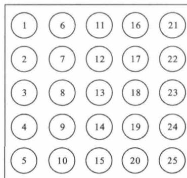
图2 激光功率测试采样点分布图
