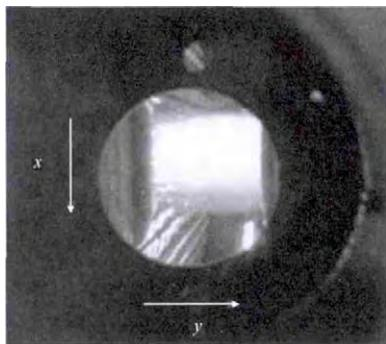
图 4 非链式脉冲 DF 激光器放电照片
