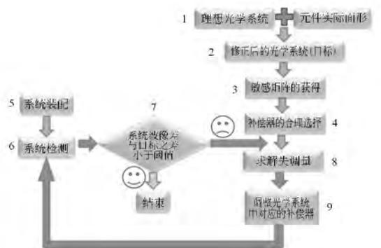
图 1 微缩投影系统计算机辅助装调流程
