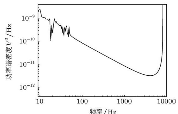
图 3 OMP 算法的  $1/f$  噪声估计
