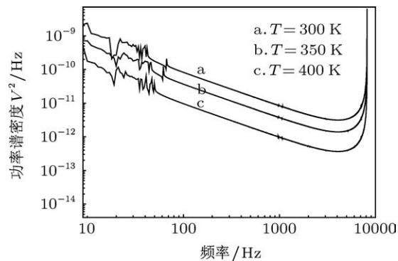
图 7 样品 1 激光器  $1/f$  噪声与结温的关系曲线
