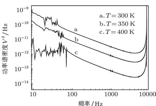
图 9 样品 3 激光器  $1/f$  噪声与结温的关系曲线
