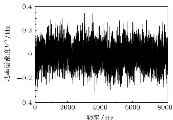
图 1 高功率半导体激光器中的噪声功率谱
