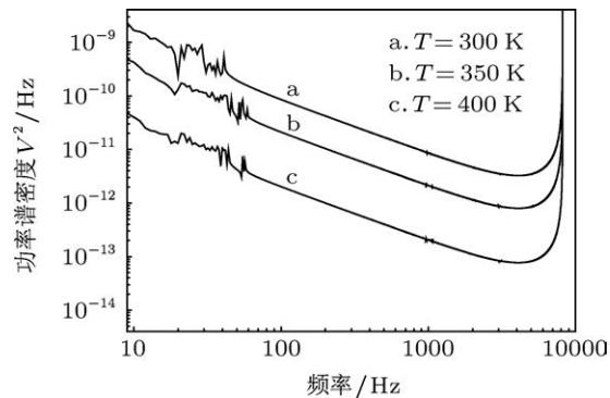
图 8 样品 2 激光器  $1/f$  噪声与结温的关系曲线
