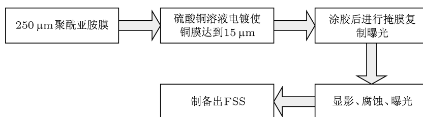
图8 FSS制备工艺流程
