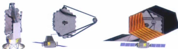
图 3 ATLAST 的 16.8m 主镜设计方案
