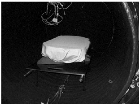
图 9 反射镜组件真空热循环试验
