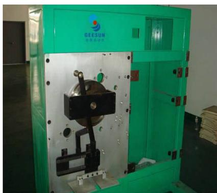
图17 凸轮机械手原理样机
