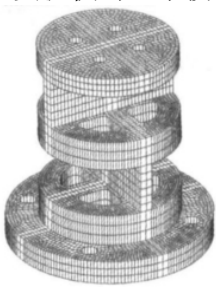
图 4 柔性支撑的有限元模型 Fig. 4 The finite element model of flexible support
