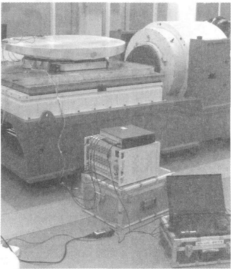
图 12 反射镜组件随机振动试验现场
