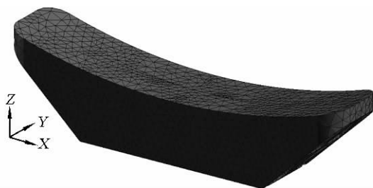
图 5 反射镜有限元模型
