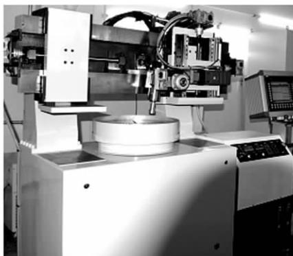
图1 超光滑加工机床的结构
