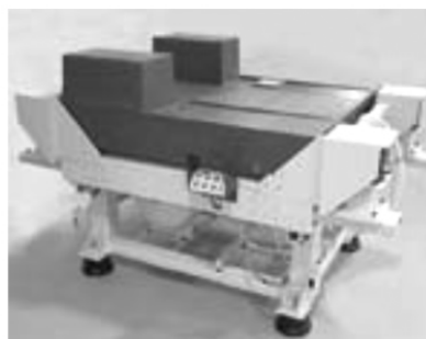
图7 Nanoform 700 ultra 的床身与隔振系统
