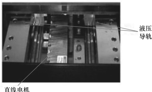
图8 液体静压导轨与电机直驱技术
