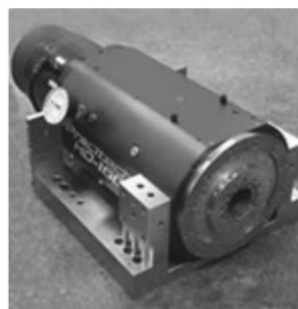
图10 Nanoform 700 ultra 的主轴 HD-160
