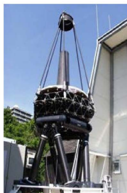
图9 大型射电天文望远镜调姿装置 图10 机械灵巧手
