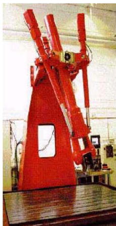
图4 HexaGlide并联机床 图5 Tricept 600并联机床 的HexaGlide 并联机床, 图5是瑞典 Neos Robotics 公司生产的 Tricept 600 型并联机床。
