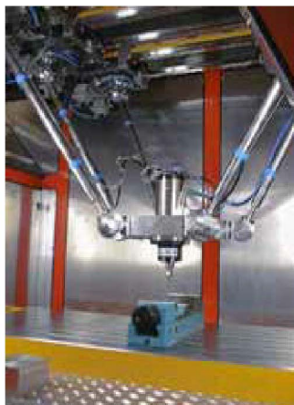
图4 HexaGlide并联机床 图5 Tricept 600并联机床 的HexaGlide 并联机床, 图5是瑞典 Neos Robotics 公司生产的 Tricept 600 型并联机床。
