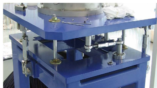
图 13 光束线六杆并联机构的实际应用
