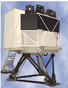
图3 波音737-400飞行模拟器
