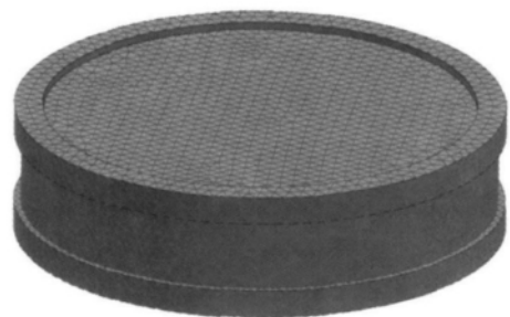
图2 标准镜有限元模型
