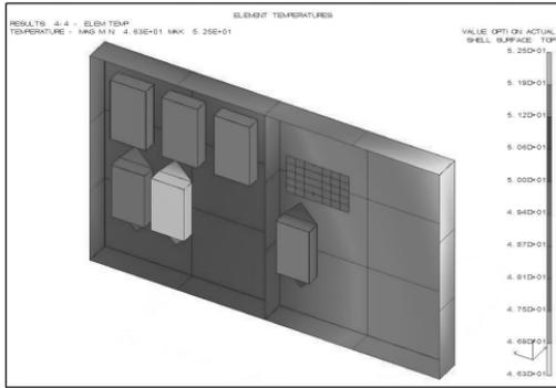
图 4 电源板 1 温度分布云图
