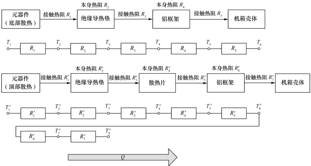
图 2 元器件导热路径及热阻模型
