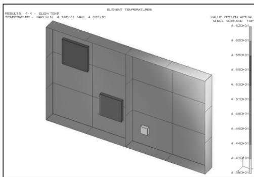
图 6 控制 PCB 温度分布云图
