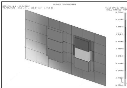
图 5 箱体侧壁温度分布云图
