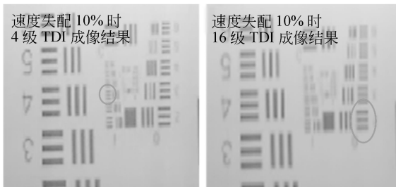
图 13 像移速度失配 10% 时, 4 级和 16 级成像结果 Fig. 13 4-TDI and 16-TDI images at 10% image motion velocity mismatch
