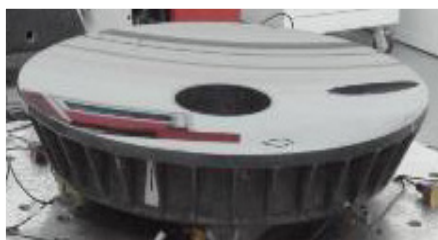
图 3 \phi 620 mm 口径 RB-SiC 反射镜
