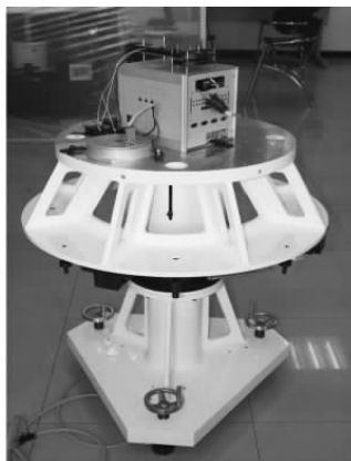
图6 自研的高精度小型三轴气浮台
