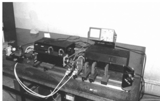
图5 光束扫描激光掩模微加工实验装置
