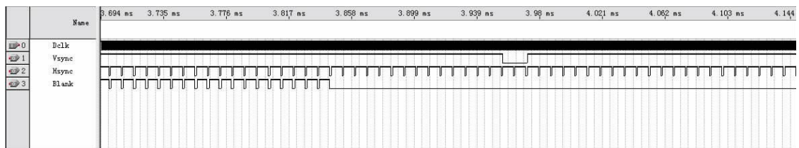
图 7 VGA 显示信号时序仿真图
