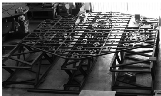
图3 车间装配中的支撑桁架
