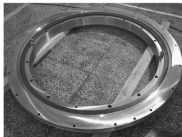
图 20 \Phi 1\ 500 \text{ mm} 精密双排异径球转盘轴承
