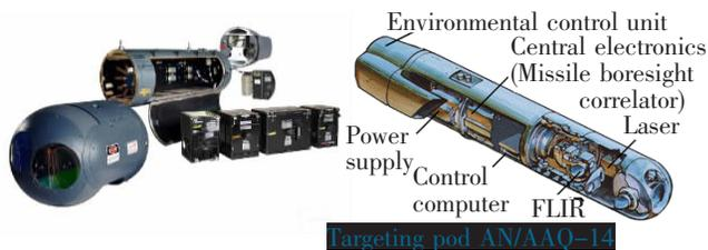
图 2 蓝盾吊舱及结构
