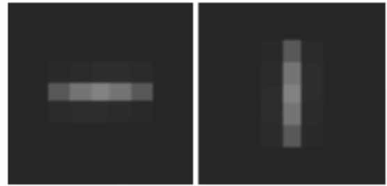
图4 水平和垂直条形滤波器
