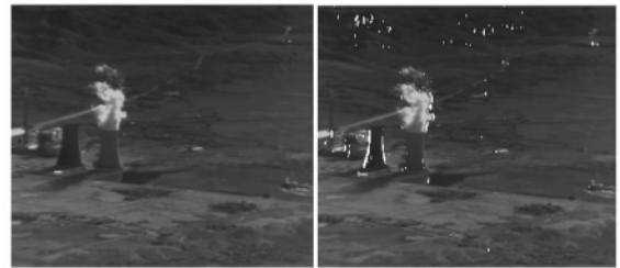
图5 经垂直条形滤波后提取垂直轮廓的图像
