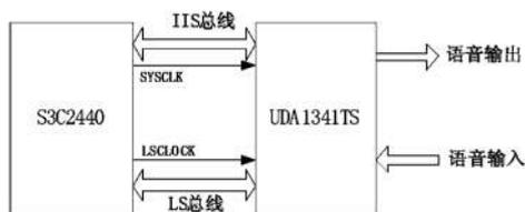
图3 语音采集芯片与2440连接电路连接图
