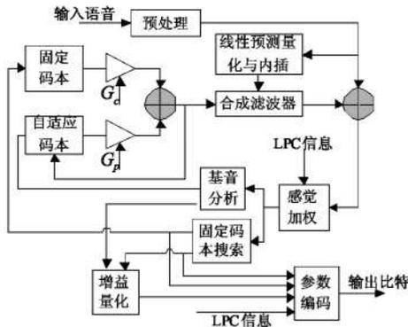
图1 G.729 音频编码算法结构图
