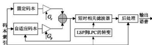
图2 G.729 音频解码算法结构图
