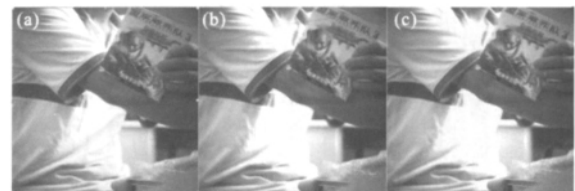
图 6 室内原始 CFA 图像,白平衡校正前和自适应白平衡校正后的图像
