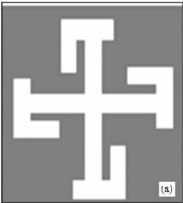
图 3 两种 FSS 结构的周期单元
