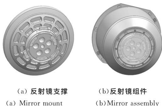
图 3 反射镜支撑及组件 Fig. 3 Mirror mount and assembly
