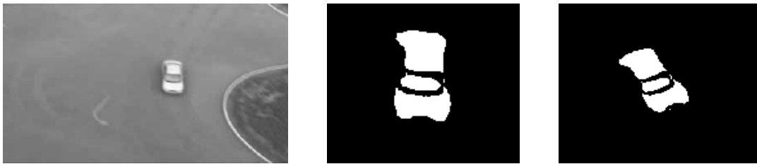
图 5 原始图像及旋转后目标位置的二值化图像 Fig.5 Original image and its binary tracking window
