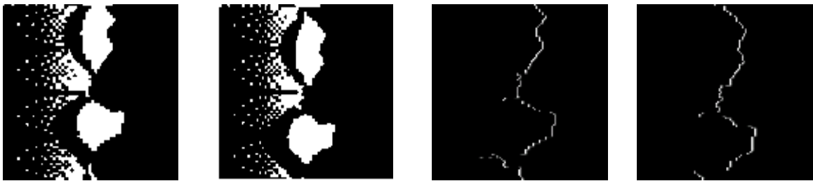
图 6 对数极坐标模型下的目标图像及对应的特征提取图像 Fig.6 Target log-polar image and the feature extracted image.
