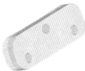
图 2 优化前反射镜有限元模型 Fig.2 FEM of mirror before optimization
