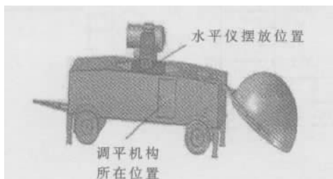
图 2 电子水平仪应用在车载转台系统示意图
