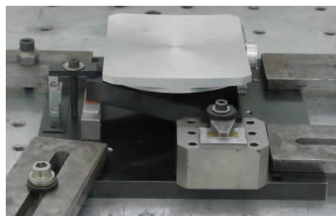
图5 发射镜组件及试验工装
