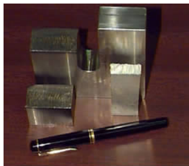
图 8 COIL 切割不锈钢和铝材断面图, 前面放置的钢笔长 127 mm。
