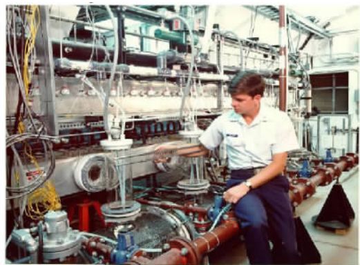
图 3 亚音速和超音速 COIL 大小对比照片。背景的大激光器 (COIL IV) 具有 4 m 增益长度, 0.5 mole/s Cl_2 气流速, 功率约 4 kW。图中工作人员手持 25 cm 长超音速激光器的喷嘴, 为 0.2 mole/s Cl_2 气流速, 功率约 2 kW [6] 。
