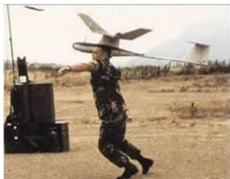
图2 指针无人机手抛式发射
