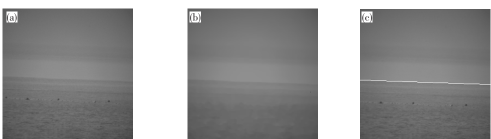
图 9 (a)天空和海面分层且有物体噪声的图像;(b) 中值滤波结果;(c)海天线未受分层干扰.
