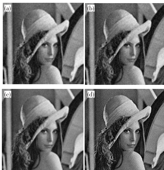
图 4 低分辨率序列重建结果。(a) 双线性插值图像;(b) 基于梯度的插值图像;(c) 传统的 POCS 算法重建高分辨率图像;(d) 本文算法重建高分辨率图像。
