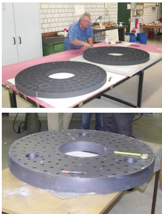
图7 采用渗硅技术连接起来的SiC反射镜
