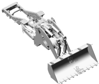
图4 对称工况刚-弹耦合模型
