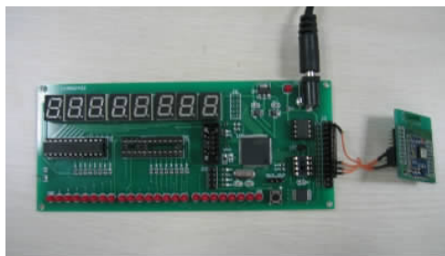
图5 单片机与蓝牙连接实物图
