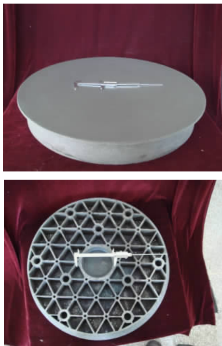
图 1 碳化硅镜坯与轻量化
