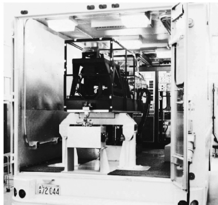
图5 包含 \text{CO}_2 相干激光雷达的可运输多传感器系统
