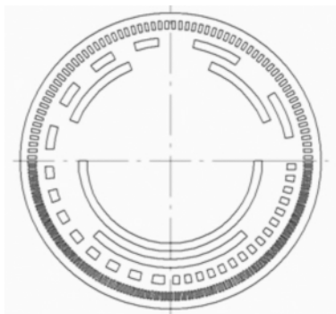
图 8 10 位矩阵码编码码盘
