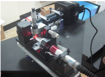
图 4 装调后的 Hartmann 传感器
