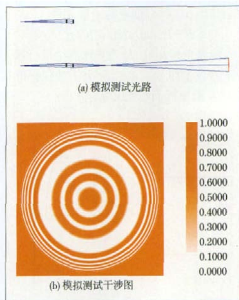
图5 计算机模拟标准球面波检测非球面镜
