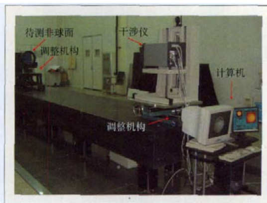
图6 环形子孔径拼接检测非球面设备装置图
