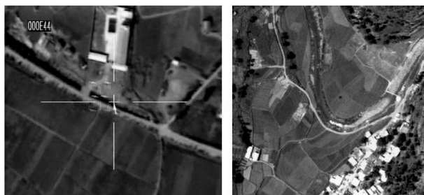
无隔振时光电 吊舱航空拍图
